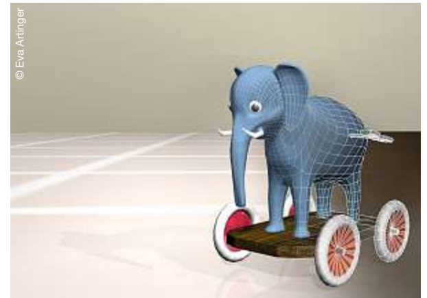
Vom Drahtgitter- zum Renderingmodell: Auf diese Weise werden Lichtverteilung und Oberflächeneigenschaften berechnet und dargestellt.
