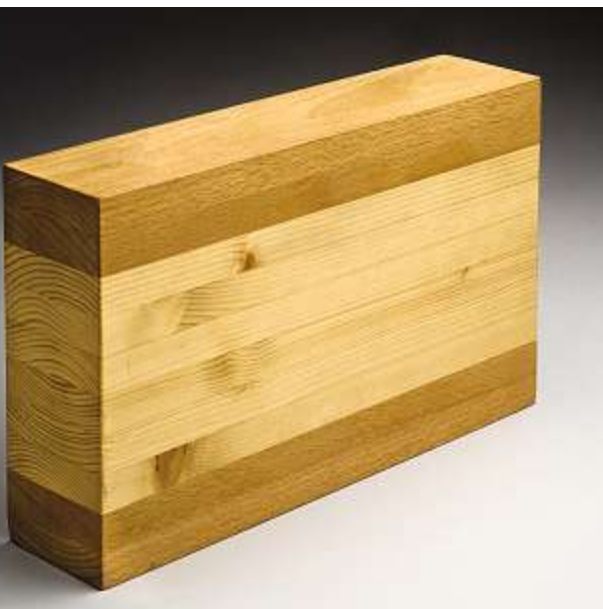
Hybridträger aus Buchen- (außen) und Fichtenlamellen (innen). Durch die Anordnung der Buchenlamellen erhöht sich die Tragfähigkeit gegenüber Brettschichtholz aus Fichte.
