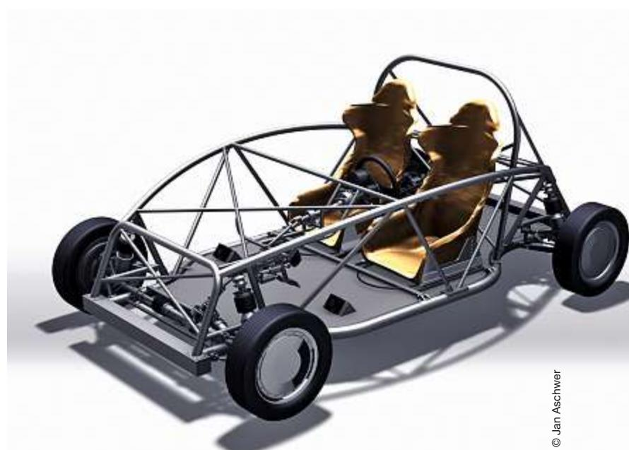
Am Versuchsfahrzeug EF1 wird die Funktionalität radselektiver elektrischer Antriebe untersucht.
