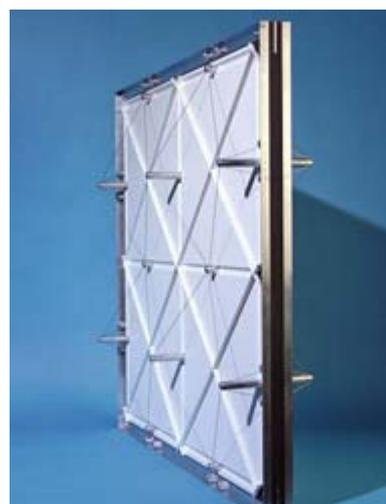
Modell einer Außenwand mit Vakuum-Dämmsystemen im Maßstab 1:1.
