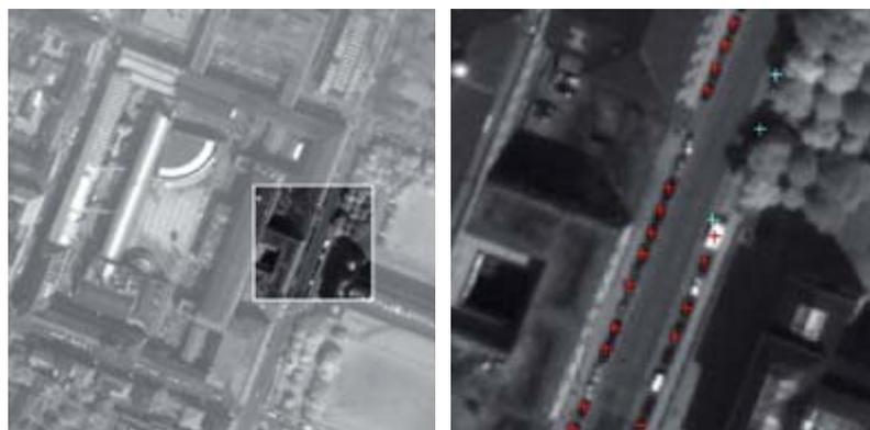
Abb.1 Links: Panchromatisches Satellitenbild des TUM-Stammgeländes, aufgezeichnet vom Satelliten Quickbird. Die Auflösung am Boden beträgt etwas mehr als 60 cm, so dass die Mehrheit an Fahrzeugen visuell identifizierbar ist. Rechts: Ergebnis der automatischen Fahrzeugdetektion; korrekt erkannte Fahrzeuge tragen rote, Fehlextraktionen blaue Kreuze.
