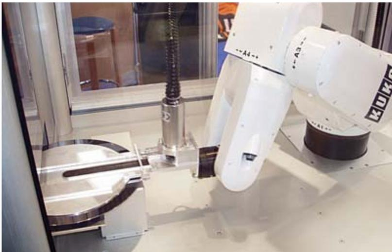
6-Achs-Roboter mit berührungslosem Greifer für Scheiben mit einem Durchmesser von 300 mm.
