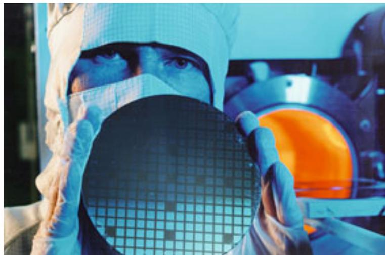
Wissenschaftler im Reinraum mit einer prozessierten Siliziumscheibe; im Hintergrund eine MOCVD-Anlage zur Schichtabscheidung.
