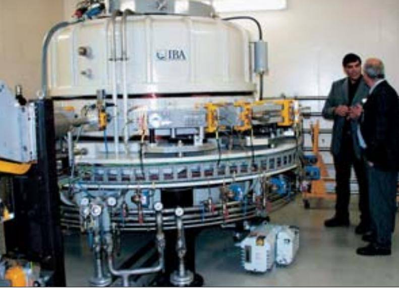
**Der Elektronenbeschleuniger in Saal an der Donau gehört mit 150 MW Strahlleistung und 10 MeV Beschleunigungsenergie zu den leistungsfähigsten der Welt.**
