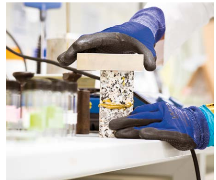
Nach dem Zusammenfügen der Granitprüfkörper werden sie mit 2 kg Gewicht belastet, bis der Schmelzklebstoff erkaltet ist.
