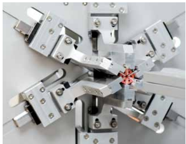
Experimental-Crimpanlage zur zirkulären Fixation und Montage eines Stents auf dem Dilatationskatheter vor der Einführung in ein Herzkranzgefäß / Using a crimping device a stent is mounted and fixed on a dilatation catheter surface before insertion into a coronary artery
