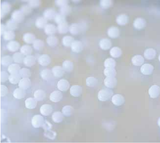
Kunststoffgranulate verschiedener biokompatibler Polymere werden vor dem Aufschmelzen für den Spritzgießprozess mit Mikroorganismen kontaminiert / Granules of various biocompatible polymers are contaminated with microorganisms before starting the injection molding process
