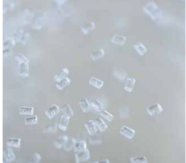
Kunststoffgranulate verschiedener biokompatibler Polymere werden vor dem Aufschmelzen für den Spritzgießprozess mit Mikroorganismen kontaminiert / Granules of various biocompatible polymers are contaminated with microorganisms before starting the injection molding process
